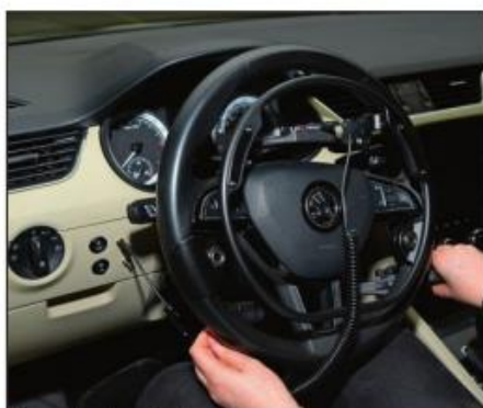
Gut zu sehen: der aufgesetzte Gasring.
